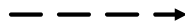
Figur 27. EBML-symbolen för en implicit koppling mellan två processer i en statisk processmodell, där destinationsprocessen inte kan starta utan att den föregående processen avslutats.
