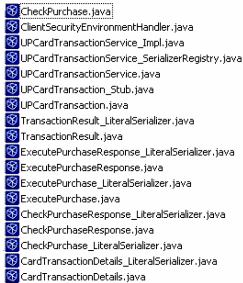
Fig. 7.1. Källkodsfiler genererade av wscmpile.
